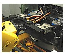
每套系統提供一組機器人夾爪,該 夾爪上具備吹氣功能,可清理加工後之 金屬殘屑,另該夾爪可設計為快拆式, 於治具更換後即可持續進行生產。
