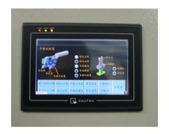
智慧型人機界面,可啓動或停止該 自動化系統,並可監控自動化系統之生 產狀況,其中含異常履歷之紀錄。
