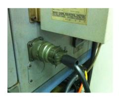
採用軍規快速接頭,可快速與工具 機進行訊號連線。
