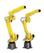
該系統採用日本原裝FANUC M20-ia 機器手臂,重量為250kg,屬6軸式高精 度機器手臂,該手臂最大荷重為20kg, 最大作業半徑為1,811mm,重複精度 ±0.08mm,工作溫度 0 ℃ 至45 ℃,溼 度75%以下。
